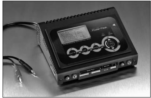
Power Peak 14 EQ-BID No. 8507 Intelligente hoog laden lossen van de 4e Generatie comfortabel met batterij management voor NC, NiMH, lood, Life, Lilo, LiPo batterijen, met geïntegreerde equalizer en GLB-Touch Operation System. NC-accu's: 1...30 cellen NiMH-accu's: 1...30 cellen Lood-accu's: 1...6 cellen Lithium-accu's: 1...12 cellen Laad-ontlaadstroom 0,1...10 A
